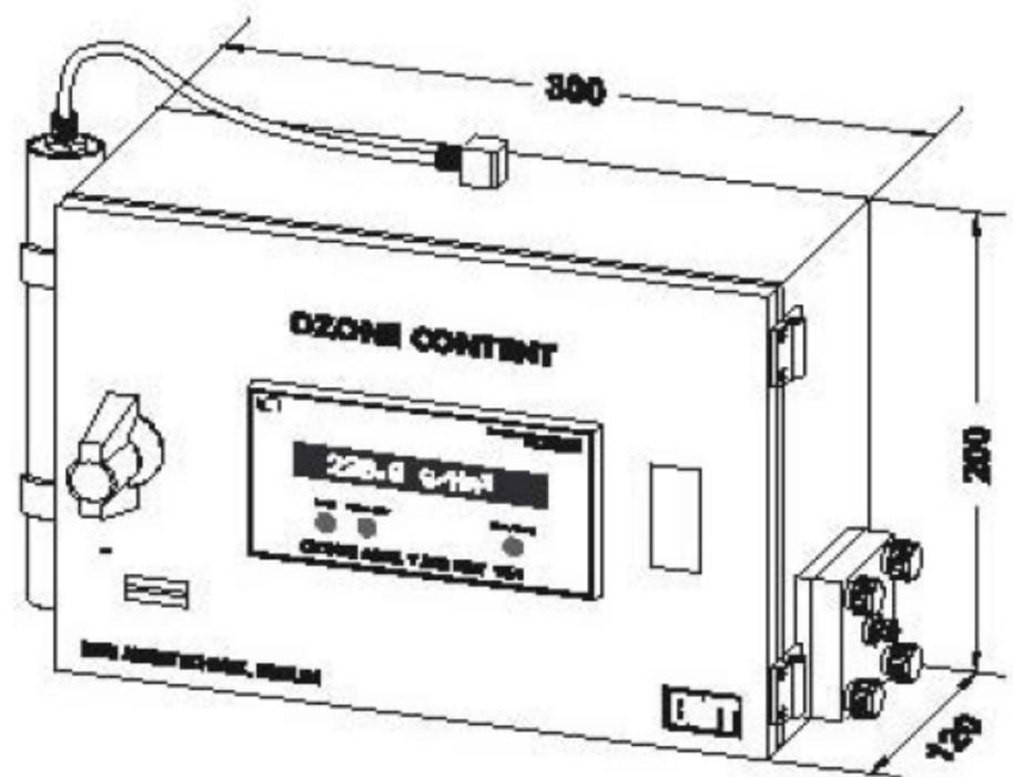
臭氧分析仪 BMT-964 C 被封装在一喷塑的铝制外箱中，空间需求 (开门,配置样气管与线缆连接) 接近 480 × 240 × 420 毫米 (宽 × 高 × 深)，外箱可以经由後方四个托架安装在牆上 (四个 6 毫米内径的固定孔,宽 × 高间隔为 240 × 225 毫米)。
